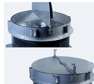
Kłapa zwrotna Zapobiega wlotowi powietrza i wody deszczowej, gdy wentylator jest wyłączony.
