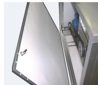
Niski poziom hałasu (izolacja z melaminy).
