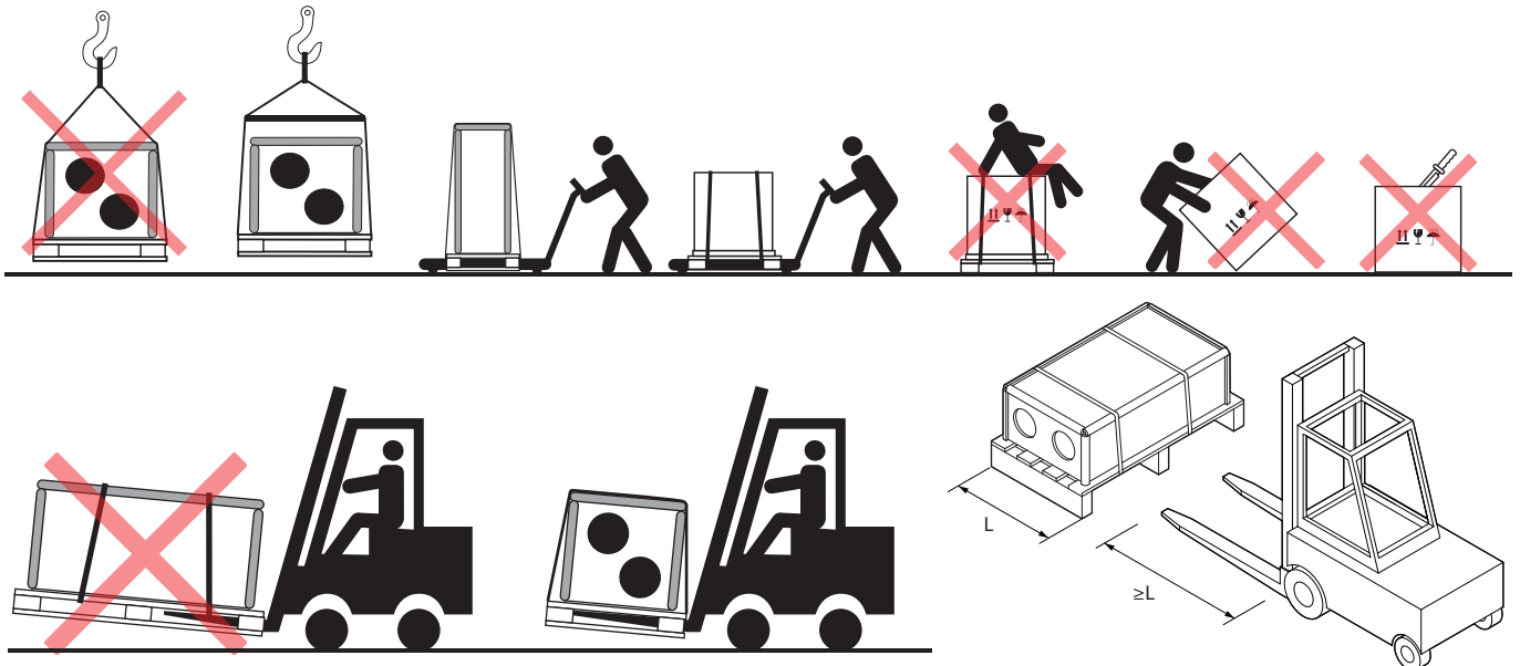
Rys. 4. Przykłady transportu dźwigiem, wózkiem widłowym lub paletowym.
